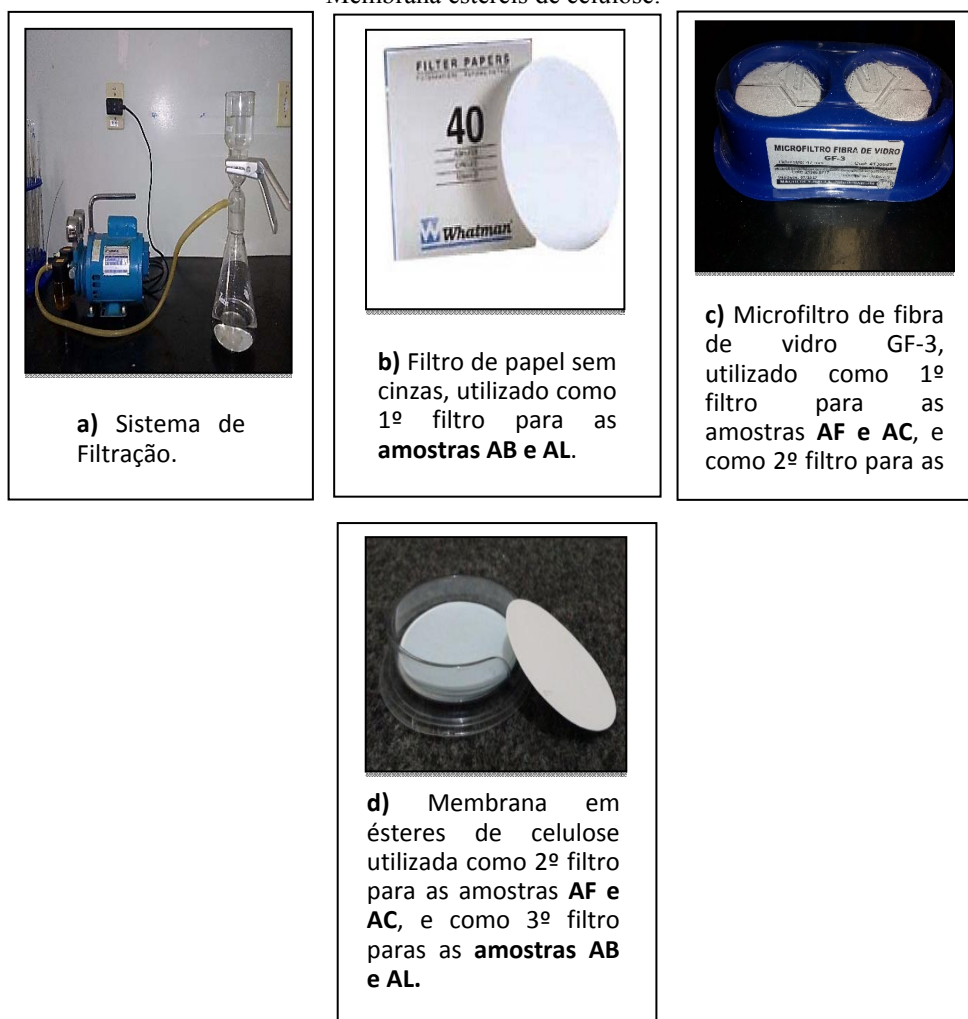
Figura 16 – a) Sistema de filtração, b) Filtro de papel com cinzas, c) Microfiltro de fibra de vidro e d) Membrana estéreis de celulose.
